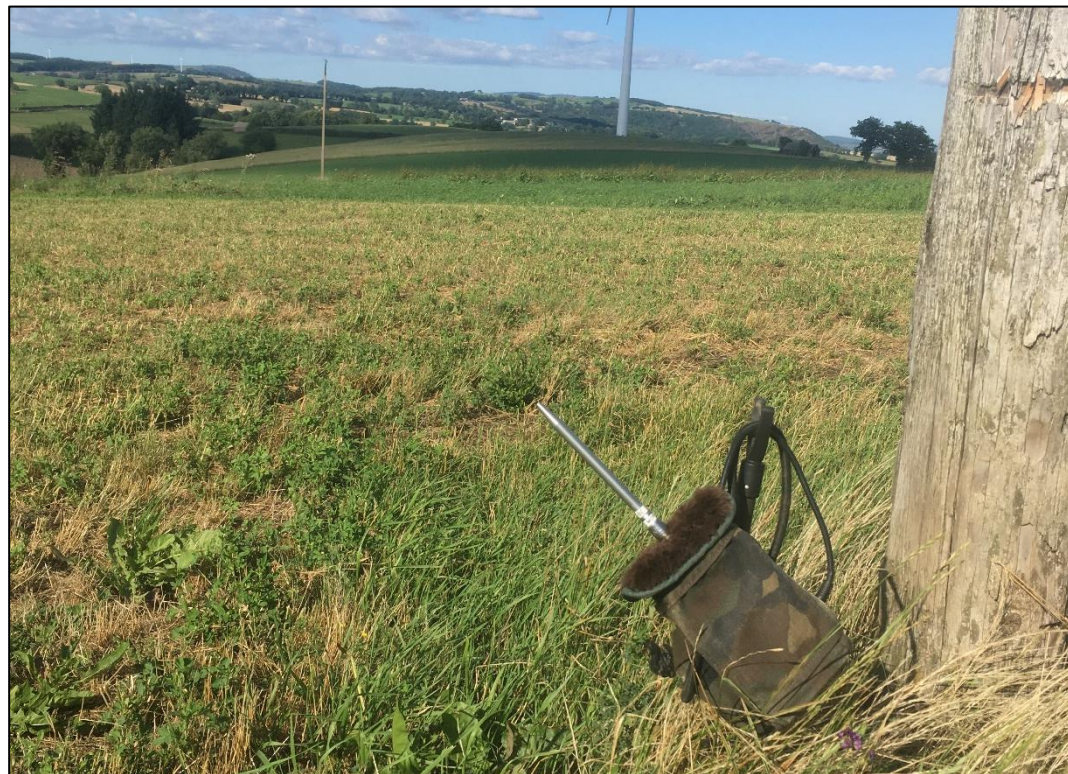
Figure 25 : Cliché d'un Batcorder « manuel » positionné sur le terrain
